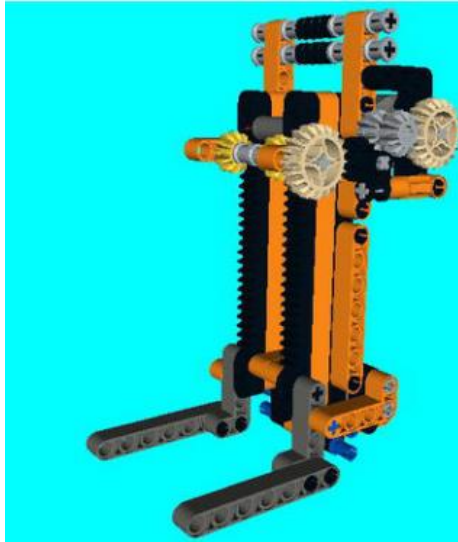
Hình 7.4 Cơ cấu nâng sử dụng cơ cấu thanh răng – bánh răng.
