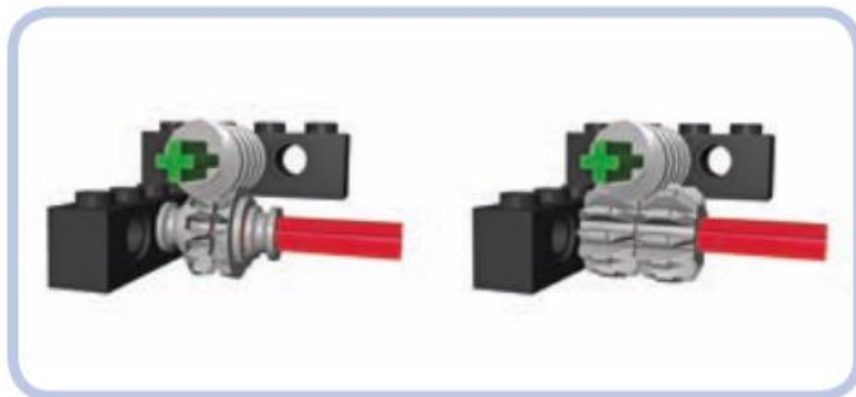
Hình 4.7 Ăn khớp giữa bánh răng côn, côn kép và trục vít.
