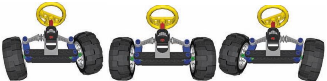
Hình 6.8 Cơ cấu lái ở vị trí quẹo trái, ở giữa và quẹo phải.
