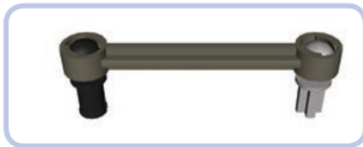
Hình 2.33 Hai chốt đầu hình cầu được kết nối để có thể di chuyển tương đối với nhau.
