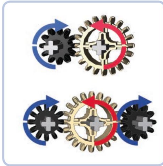
Hình 4.2 Chiều quay của các bánh răng ăn khớp
