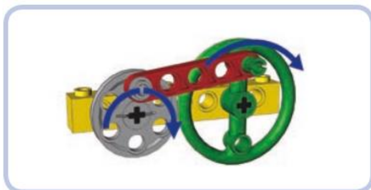
Hình 6.14 Cơ cấu với hai đĩa nối với nhau bằng một thanh. Đĩa nhỏ quay hết hành trình(vòng), và đĩa lớn quay một phần qua lại.
