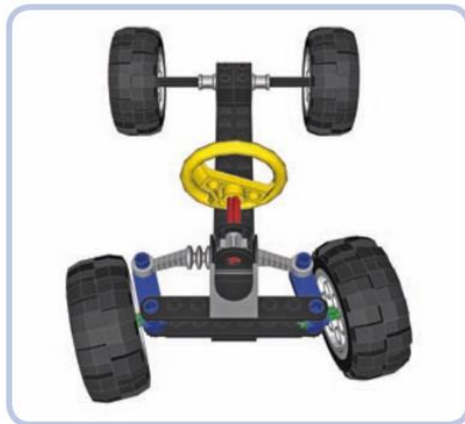
Hình 6.11 Xe LEGO cơ bản với hai trục : một trục cố định và một trục lái.
