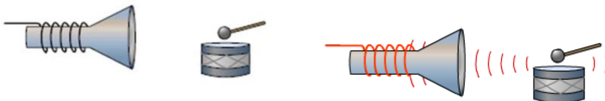
Hình 9.7 Mô phỏng cấu tạo cảm biến âm thanh
